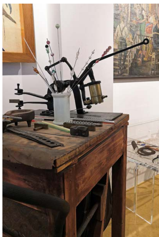
Foukací stůl s Pitzkovým strojkem a měchem.
