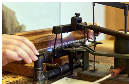
Horní část současného foukacího stolu – zleva hořák, forma a pumpička s hadičkou.
