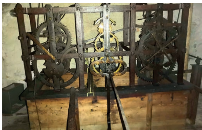
Hodinový stroj tiká díky obětavé péči pana Zdeňka Jirouše dodnes a díky důmyslnému zařízení otáčí ručičkami na všech čtyřech cifernících.
